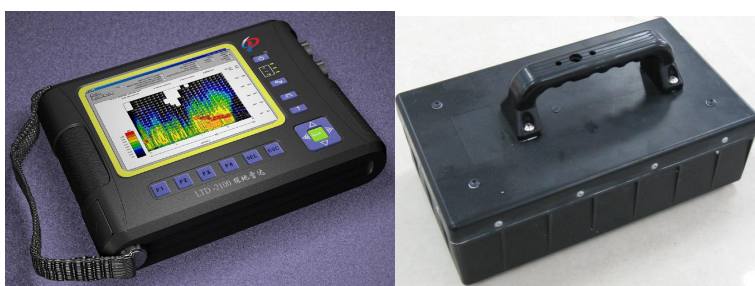
图 3 国产 LTD-2100 型探地雷达主机及 900M 天线
