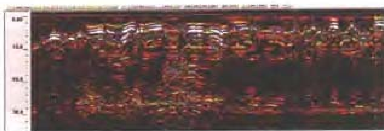
图 7.8 衬砌混凝土背后存在不密实缺陷
