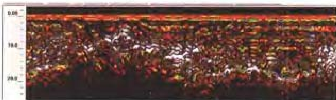
图 7.7 边墙超挖回填片石间存在空隙，不密实
