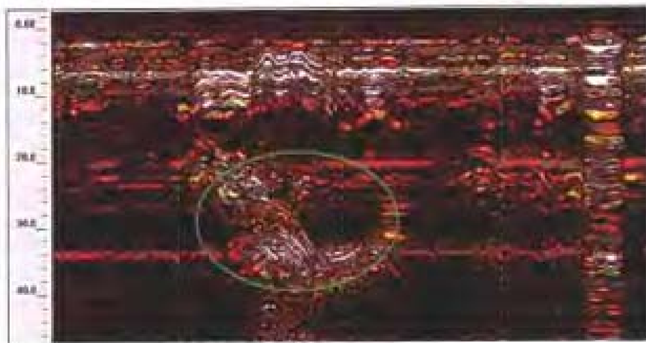
图 6.15 没有揭露的隐伏溶洞
