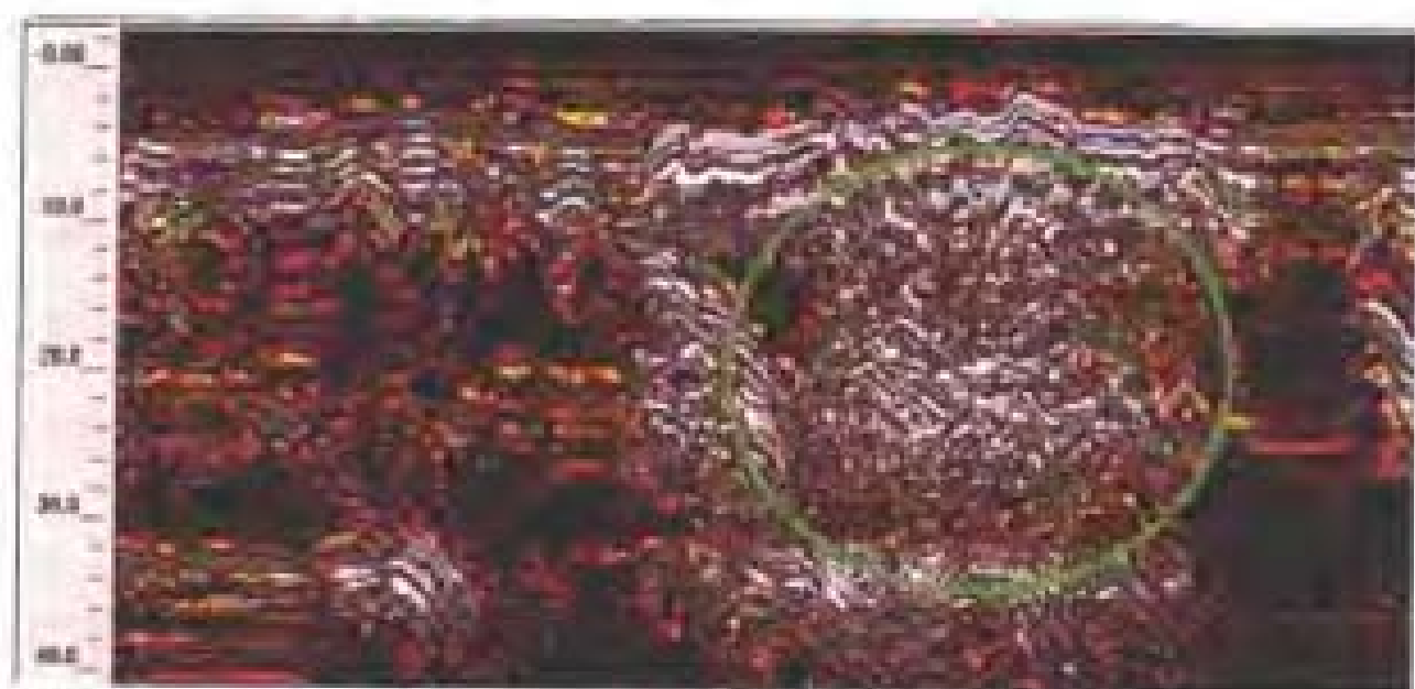
图 6.8 衬砌背后的溶洞，图像显示大的空洞
