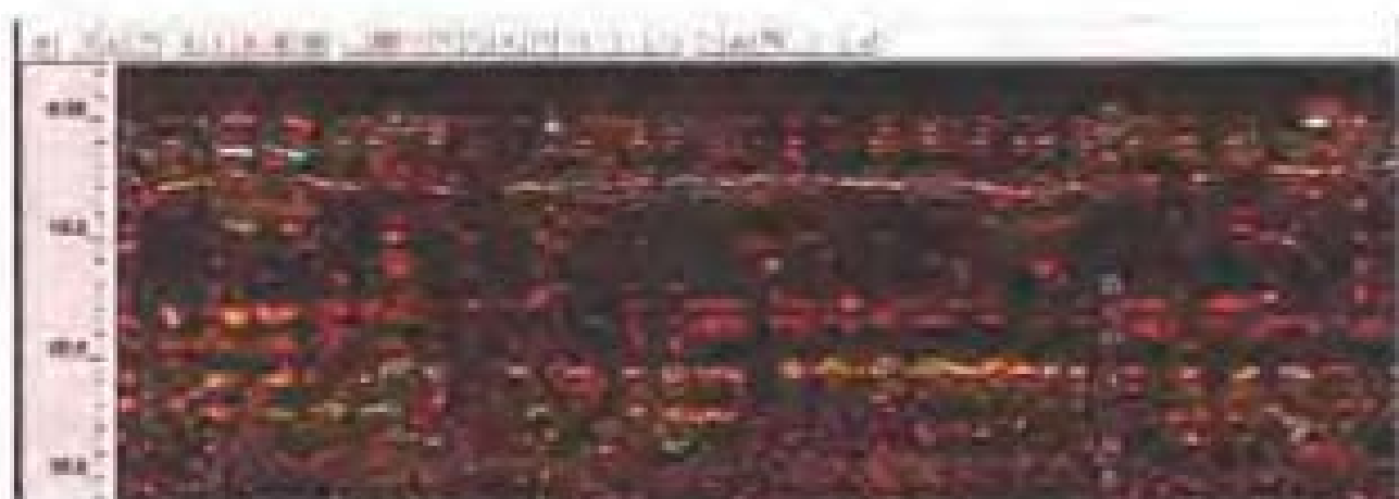
图 7.17 隧道底板检测图像
