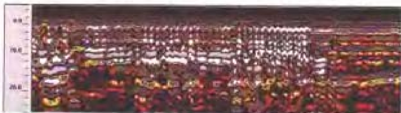
图 7.14 钢筋混凝土衬砌，背后空洞
