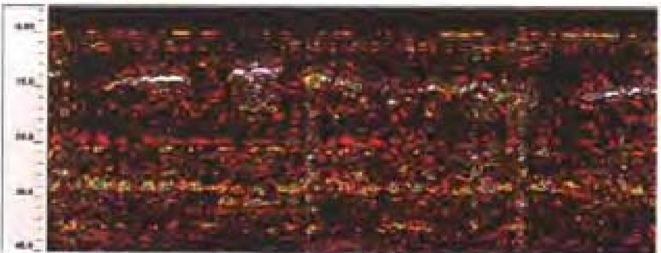
图 7.16 隧道基床检测图像
