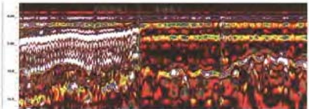
图 6.24 钢筋混凝土的雷达图像
