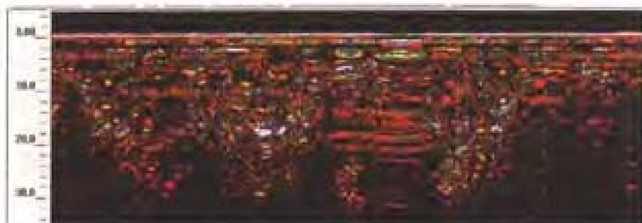
图 7.6 拱部塌方浆砌片石处理，砂浆局部不饱满，不密实
