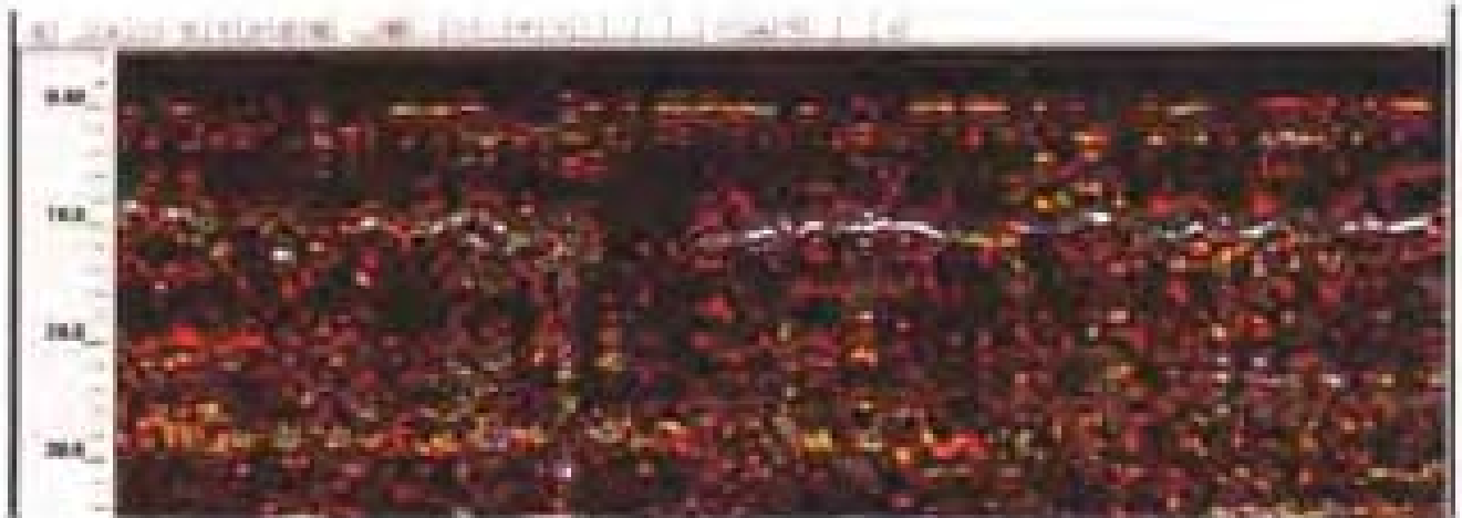
图 7.18 隧道超挖底板检测图像
