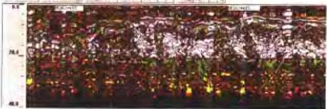
图 6.28 隧道底板雷达图像
